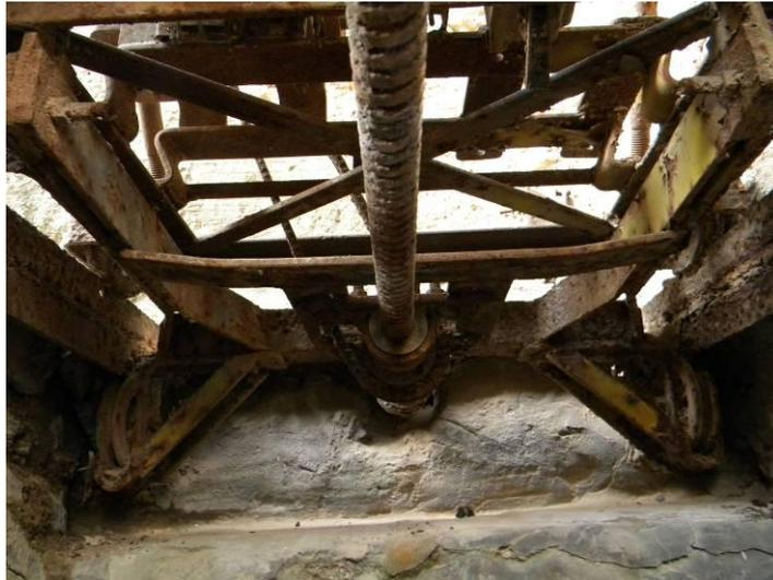
*Vista inferior de la puerta de accionamiento electromecánico*
